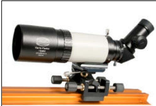
mindest bei längeren Aufnahmebrennweiten) ca. 75%. Refraktoren sind als Leitrohre besser geeignet. Zum einen kann man sie in Leitrohrschellen - oder montiert auf einem BAADER StrongHold (siehe Abbildung) - zum leichteren Finden eines geeigneten Leitsterns justieren. Zum anderen sind sie bei Temperaturänderungen fokusstabiler als z.B. SC-Teleskope. Auch eine Ortsveränderung des Leitsterns durch ein Verkippen des Hauptspiegels eines SC-Teleskops ist ausgeschlossen.
