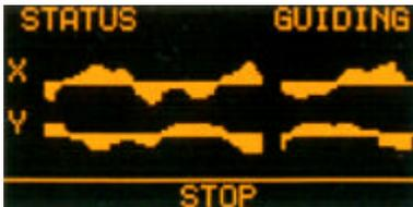
Sehen Sie in der graphischen Darstellung des Guidings sehr starke Abweichungen nach oben UND nach unten über die Zeitachse(n) so bedeutet das eine Überkorrektur. Das heißt die Korrekturbewegungen sind zu stark.
